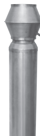
Standrohr 1000 mm doppelwandig innen isoliert mit Alu-Lamellmatte 25 mm
